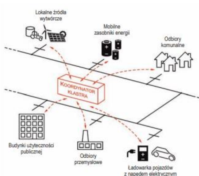
Rysunek 32. Model funkcjonowania klastra energii elektrycznej
