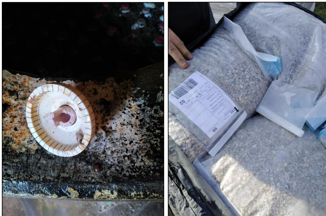
Fotografia 4.1.8 Z lewej: stara dysza filtracyjna, z prawej: nowe żłoże do filtrów pośpiesznych
